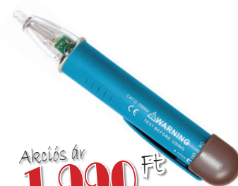
M0007A Aljakatok, tápkábelek, stb. érintésmentes feszültségvizsgálóhoz, hang és optikai jelzéssel. 70-1000V AC, tartozék 2db 1,5V AAA elemmel.
